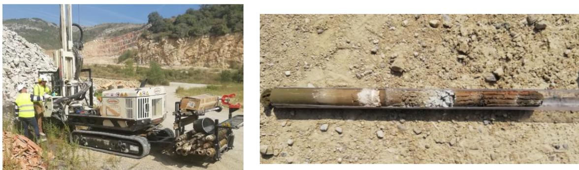
FIGURE 4 : SONDAGE AU CAROTTIER BATTU SOUS GAINE (S1)
